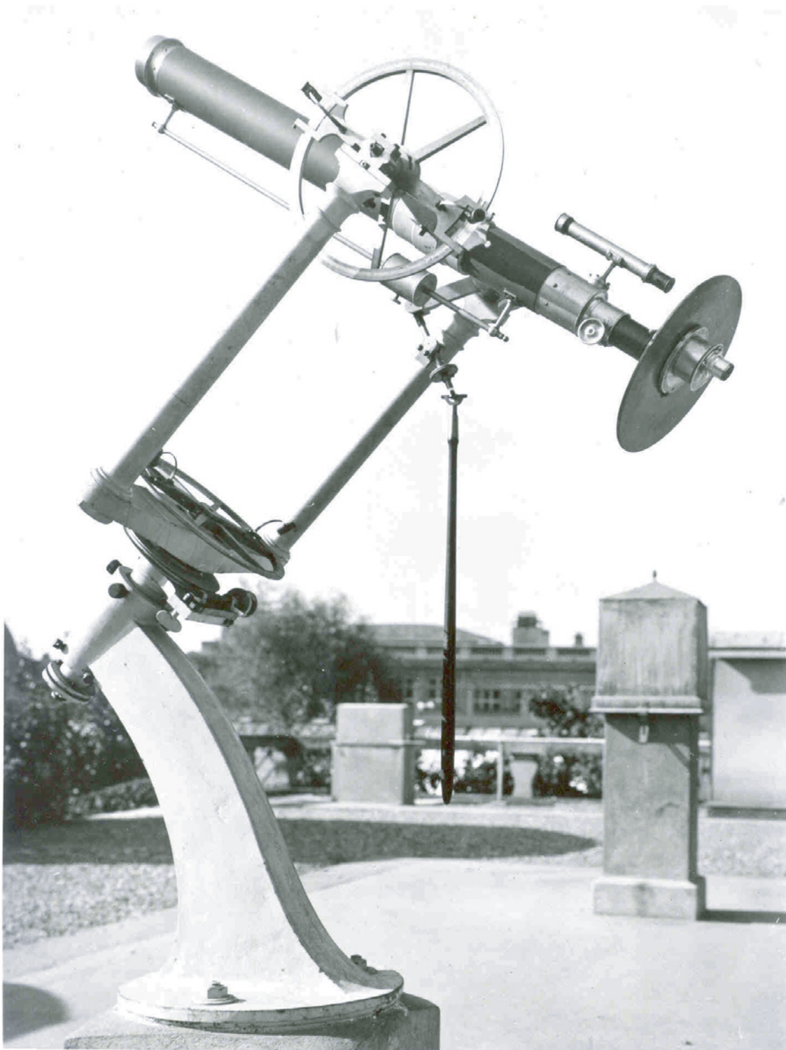
Abbildung 1.2: Der von Rudolf Wolf 1855 in Betrieb genommene Fraunhofersche 80 / 1100 mm Refraktor mit 64-facher Vergrößerung auf der südlichen Beobachtungsterrasse der Eidg. Sternwarte in Zürich. Am Tubusende ist das Merz'sche Polarisationshelioskop zur stufenlosen Dämpfung des Sonnenlichts zu erkennen, welches ein gefahrloses Betrachten der Sonnenphotosphäre ermöglicht. Aufnahme zwischen 1931 und 1956.
