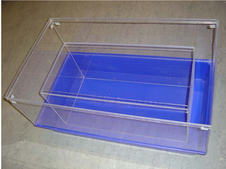
Abb. 5: Einsatz aus Plexiglas, um die zwei grösseren Käfigtiefen zu erreichen
