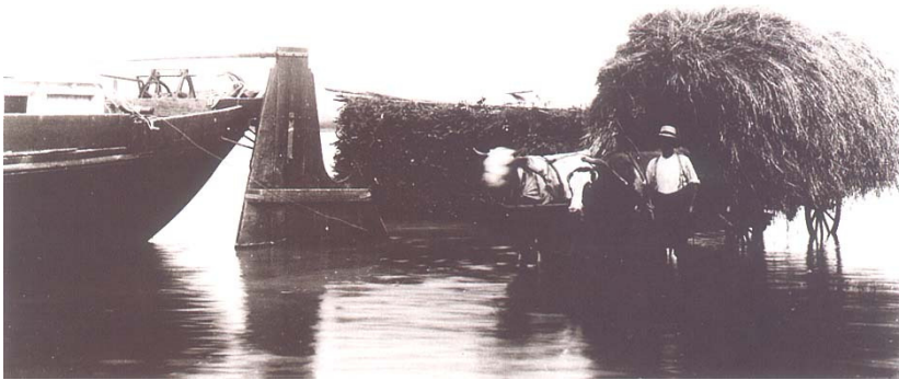
Abb. 80: Umlad an einer Landestelle. Mangels eines Quais kann das tiefgehende Schiff nicht vom Land aus beladen werden. In der Mitte des Bildes sehen wir einen mit Brennholz beladenen Nachen und rechts davon ein mit Stroh beladenes Ochsenfuhrwerk. Mit diesen beiden Fahrzeugen liessen sich in seichtem Gewässer Waren zwischen dem Schiff und dem Ufer umschlagen. Quelle: KINSKY 2000: s. 163.
