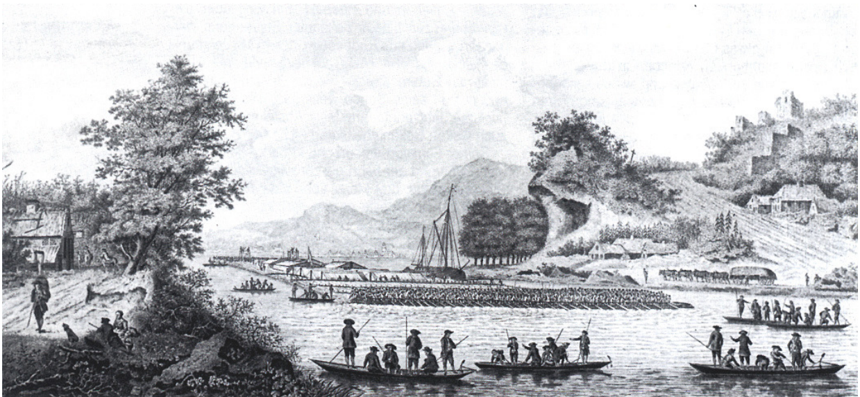
Abb. 68: Ein „Holländerfloss“. Stich von 1785. Im Vordergrund und seitlich des Flosses sind eine ganze Reihe von „Ankernachen“ zu erkennen, die mit Staken manövriert werden. Vorne auf dem Floss stehen gegen zweihundert Menschen, welche die so genannten „Streichen“ bedienen, lange Steuerruder, die aus ganzen Fichtenstämmen gefertigt waren. Auf dem Floss sind grosse Zelte zu erkennen, die Unterkünfte der Mannschaft. Ganz hinten auf dem Floss sind die beiden „Steuerstühle“ auszumachen, zwei Holztürme, von welchen die Steuerleute die Kommandos an die knapp fünfhundertköpfige Besatzung ausgaben. Rechts im Bild ist ein achtspänniges Ochsenfuhrwerk zu erkennen, die strassengebundene Konkurrenz der Rheinschifffahrt. Der fehlende Uferbewuchs rechts weist darauf hin, dass dort der Treidelpfad lief. Das bewachsene Ufer links war für einen Treidelverband unpassierbar. Quelle: BOLDT und MOLITOR 1988: s. 112.
