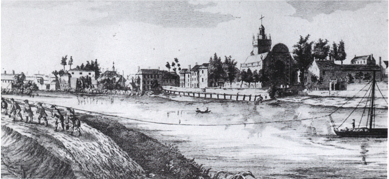
Abb. 11: Treidelzug mit sechs Schiffsziehern bei Isleworth an der Thames im Jahr 1779. Die Zugleine ist an der Mastspitze und am Bug festgemacht. Damit wurde sichergestellt, dass bei Zug der Bug nicht unter Wasser gedrückt, sondern aus dem Wasser gehoben wurde. Die Schiffszieher auf dem Treidelpfad tragen einen Ledergurt um die linke Schulter, der mit der Zugleine verbunden ist. Die nach vorn gebeugte Haltung war typisch für Schiffszieher, weil sie sich nach vorne in den Schultergurt fallen liessen, um ihr Körpergewicht für den Vortrieb zu nutzen. Quelle: WILSON 1987: s. 50.
