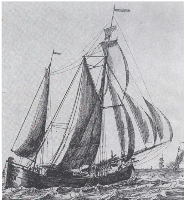
Abb. 51: Ein „ Kuff “ geht unter vollen Segeln mit dem Wind. Dieser Schiffstyp befuhr im 18. Jahrhundert die niederländischen Küstengewässer. In der Mitte des Rumpfes lässt sich das „ Schwert “ erkennen, welches an der dem Wind abgewandten Lee im Wasser liegt und verhindert, dass das kiellose Schiff vom Wind aus dem Kurs gedrückt wird oder gar kentert. Musste in seichten Gewässern das „ Schwert “ gehoben werden, war eine Reduktion der Segelfläche zwingend. Quelle: BÖCKING 1980: s. 108.
