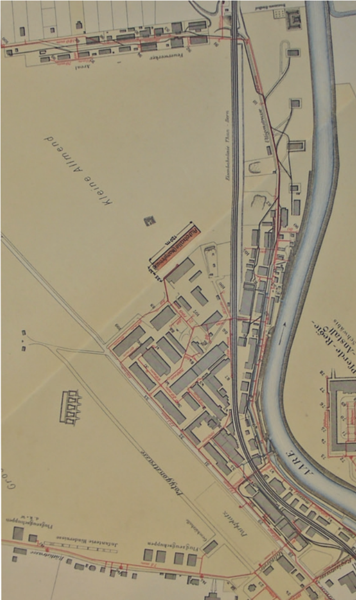
Situation 1922 (M+F). Der Plan zeigt das bestehende Schienennetz der Werkbahn (schwarz). Die geplante Kanalisation ist rot eingezeichnet (Bundesarchiv E 27).
