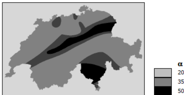
Abbildung 4-20: Zonenkoeffizient \alpha nach Zeller (1995) für das Verfahren Müller
