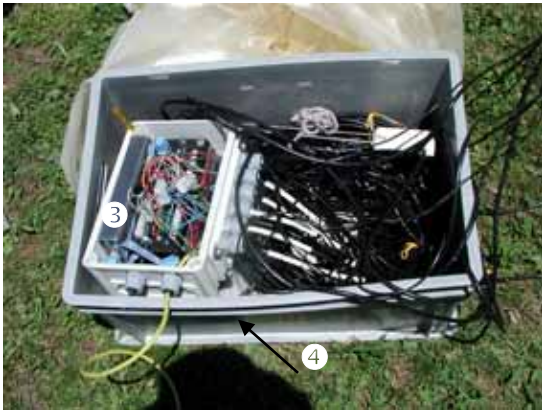
Abbildung 4-7: Messsystem für die Erfassung der Bodenfeuchte (Bild oben links: Campbell Scientific Inc., 1998)
