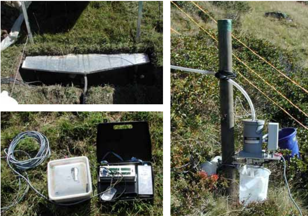
Abbildung 4-6: Versuchsanordnung zur Erfassung des Oberflächenabflusses (Oben links: Auffangblech am Profil; rechts: Wassersammler; Unten links: Logger und Stromversorgung)
