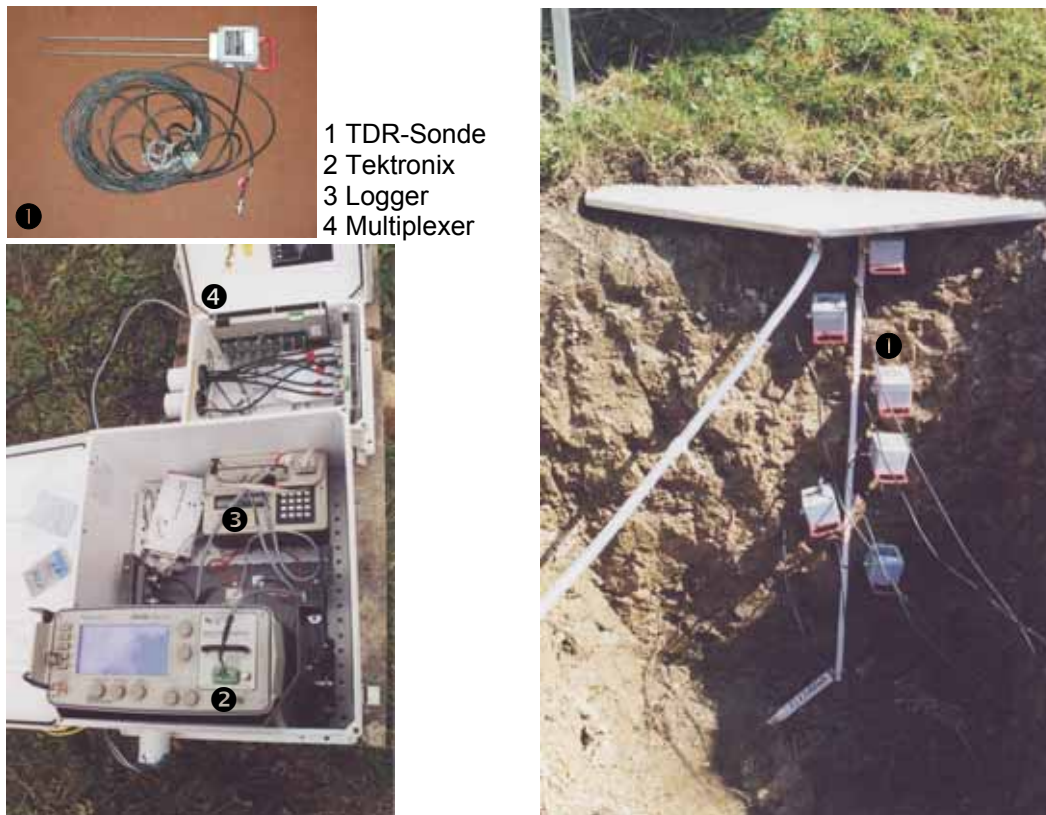
Abbildung 4-8: Messsystem für die Erfassung der Bodenfeuchte
