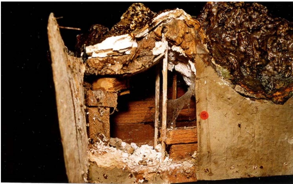
Abb.2: Pfyffer-Relief: Blick in den Innenaufbau eines der 136 Segmente. Mit den auf das Grundbrett gesteckten Stäbchen markierte Pfyffer Lage und Höhe von ausgewählten Punkten
