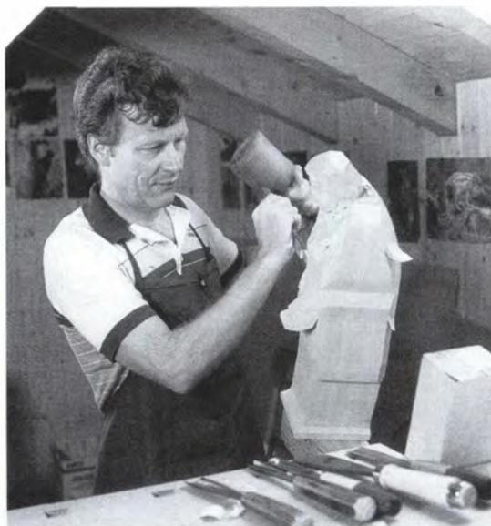
*Fritz Fuchs beim sogenannten «Ausrüsten». Das Werkstück wird über einen Holzwinkel in die Schnitzlerbank gespannt. Mit Schlegel und Meissel behauen, erhält die Figur Span um Span ihre charakterische Gestalt.*
