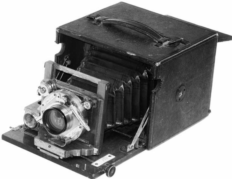
Eine Kamera Schiffmanns: es handelt sich um eine Balgenkamera, in welcher er die Fotos im Negativ auf Glasplatten bannte
