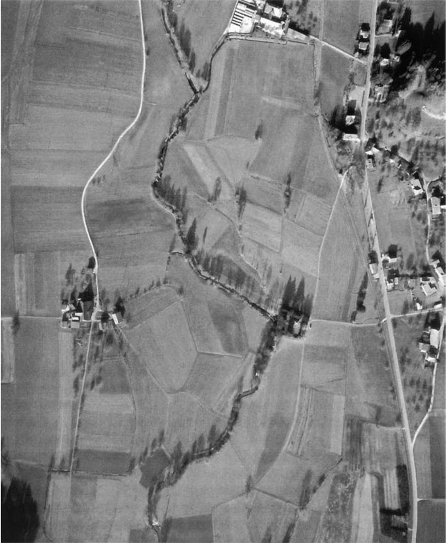
Abb. 8: Luftbild des Sohlentales südlich von Lotzwil: Die Langete fliesst von Süden (unten) nach Norden und ist durch die baumbestandenenen Ufer erkennbar. Im rechtsufrigen Vorland begrenzen ein Fahrweg (Bildmitte) und der hochliegende Mühlenkanal (oberer Bildrand) jeweils einen grossflächigen Retentionsraum (Befliegung 4. Dezember 1978, Geographisches Institut der Universität Bern).
