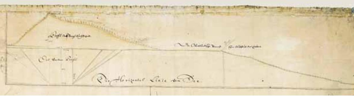
Profil durch den Strättlichgugel mit Andeutung eines Höhennivellements und «Die Horizontale Linie vom See»
