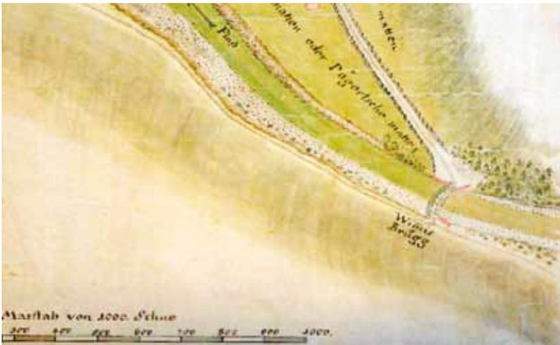
Der Plan von Reinhard aus dem Jahr 1740 zeigt die alte Holzbrücke in der Port bei Wimmis. Die Brücke muss kurz darauf zusammengebrochen sein, weil sie offenbar auf erodierbarem Grund aufgebaut war. Die Folge war der Bau (1766) der heute noch bestehenden, auf Fels fundierten Steinbogenbrücke von Erasmus Ritter. (Archiv Wimmishistoric)
