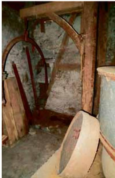
Hebeeinrichtung für die Mühlsteine
